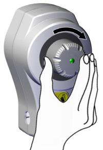
Le pousoir des unités dotées d'une fonction de dosage de sécurité comporte une flèche. Pour utiliser le distributeur, tournez le pousoir de 45 degrés dans le sens horaire. En maintenant cette position, appuyez sur le pousoir pour obtenir une dose de produit.
